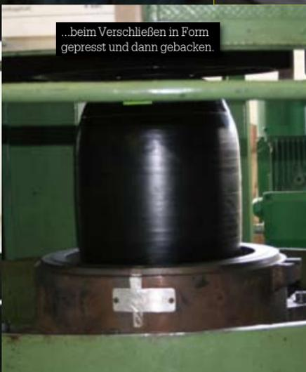
Nach einigen Minuten im „Backofen“ ist der Reifen fertig.
