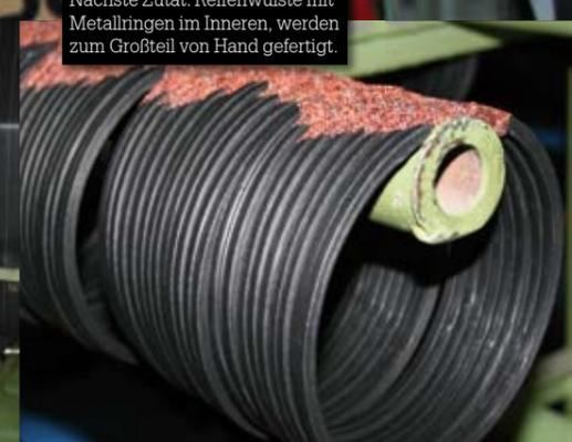
Nächste Zutat: Reifenwulste mit Metallringen im Inneren, werden zum Großteil von Hand gefertigt.
