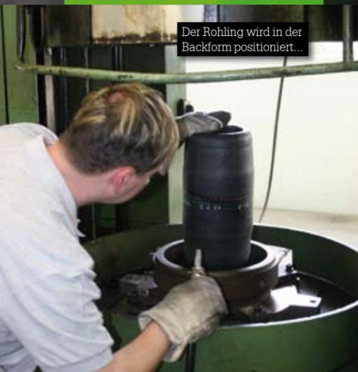
...beim Verschließen in Form gepresst und dann gebacken.
