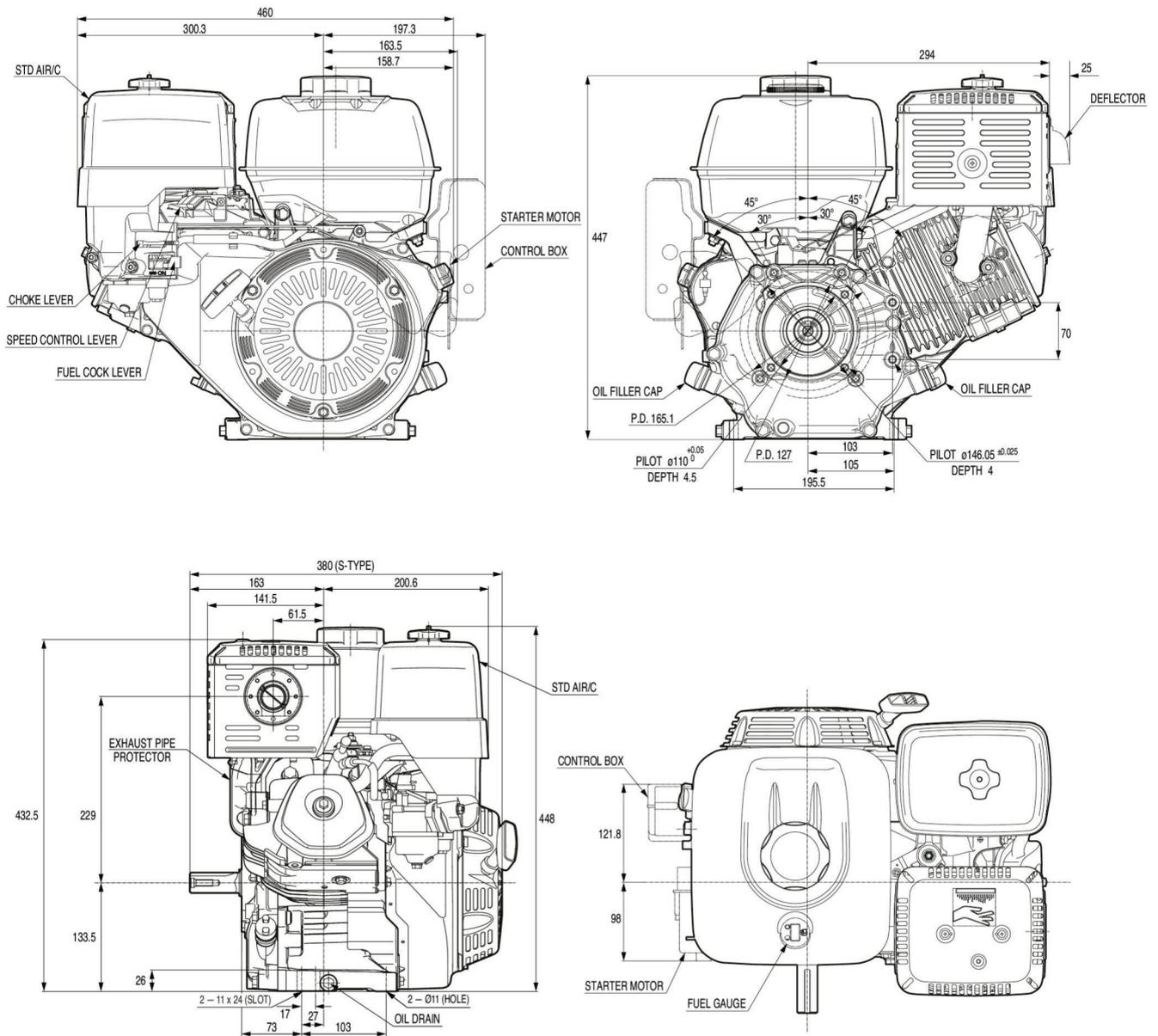
Diese technischen Zeichnungen sind die Standard-Zeichnungen, je nach Spezifikation des Motors können die Abmessungen von den Standardabmessungen abweichen.
