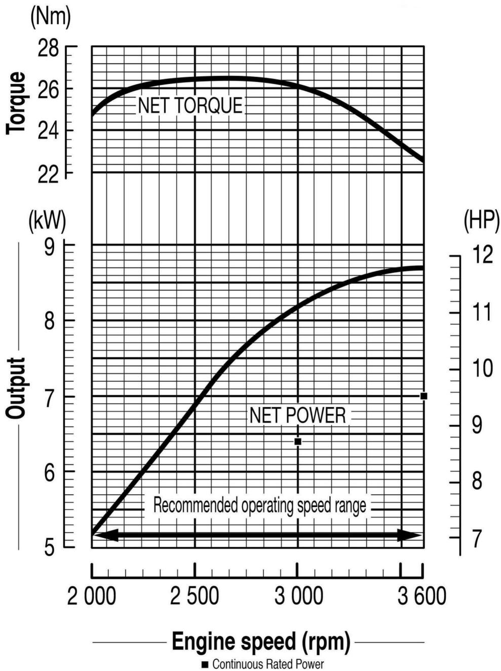
Die in diesem Dokument angegebene Nennleistung des Motors ist die Nettoleistung, die an einem Serienmotor für das Motormodell getestet und gemäß SAE J1349 bei einer bestimmten Drehzahl gemessen wurde. Massenproduktionsmotoren können von diesem Wert abweichen. Die tatsächliche Leistung des in der Endmaschine installierten Motors hängt von zahlreichen Faktoren ab, darunter die Betriebsdrehzahl des Motors in der Anwendung, die Umgebungsbedingungen, Wartung und anderen Variablen.
